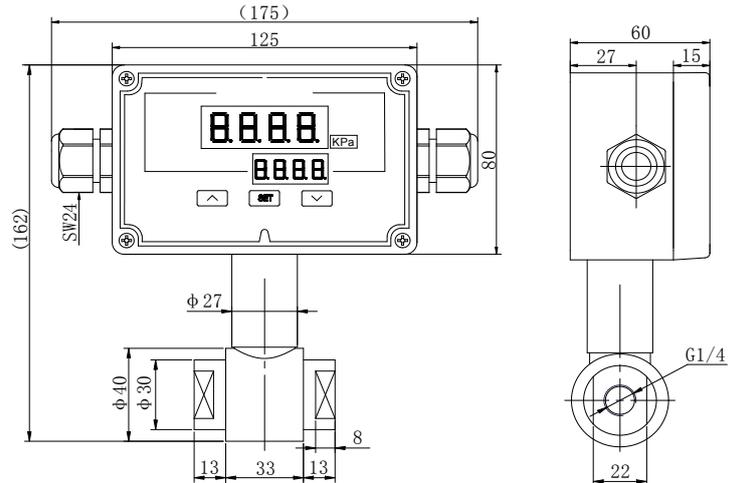
PCT460SRI 型压力控制器
