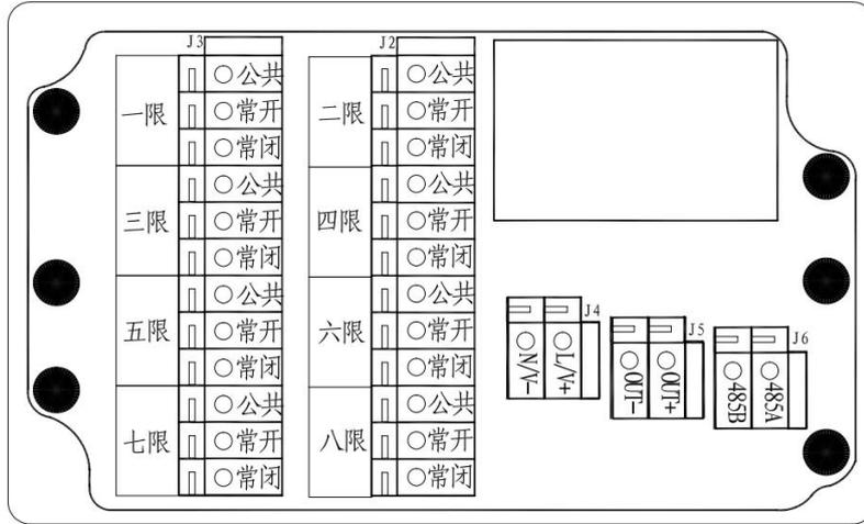
注：接线端子线径为  $0.2 \text{ mm}^2 \sim 1.5 \text{ mm}^2$ 。
