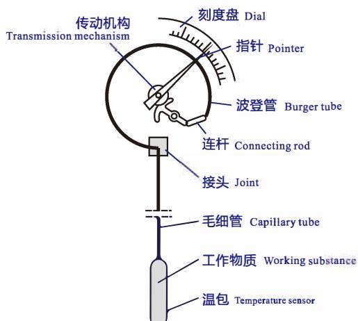
压力式温度计工作原理
