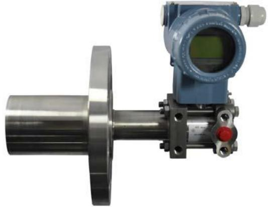
设定、过程监控等。PT30MS 系列液位变送器的测量范围（未迁移时）为 0~1kPa~2MPa，液位法兰的额定压力分别为：1.6/4MPa、6.4MPa、10MPa、150psi、300psi 或 600psi。
